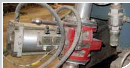
Пережимные клапаны Flowrox на заводе "GIIC"
