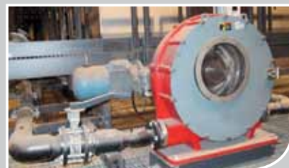
Kreislaufpumpen zur Flüssigkeitsreinigung in der Talvivaara-Mine.
