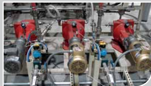
Bereits 36 LPP-D Pumpen sorgen bei James Hardie für eine verbesserte Genauigkeit von Dosieranwendungen.
