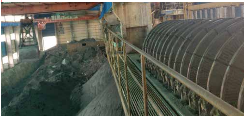
El filtro cerámico de disco Flowrox funciona extremadamente bien en la filtración de relaves de cobre.
