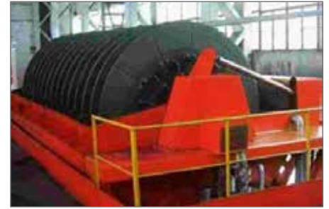
La capacidad de los filtros cerámico de disco Flowrox es alta: hasta 2000 kg DS/m 2 por hora.
