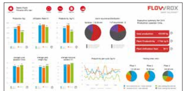
Las herramientas de solución de problemas Flowrox detectan anomalías en el proceso y envían alarmas automáticamente por correo electrónico.
