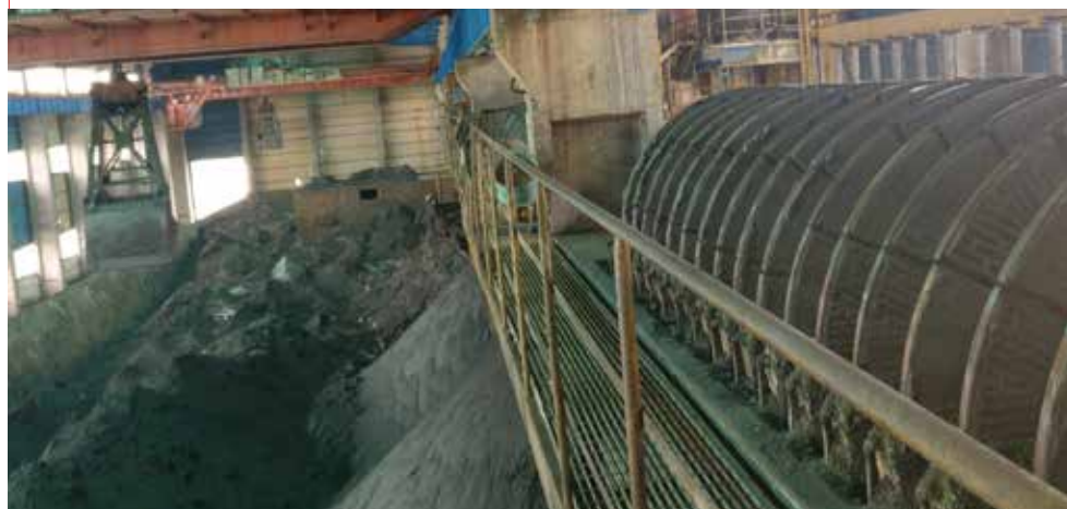
Le filtre à disques en céramique Flowrox est particulièrement efficace pour la filtration des résidus de cuivre.
