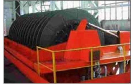
La capacité de filtration du filtre à disques en céramique (CD) de Flowrox est élevée : elle peut atteindre jusqu'à 2 000 kg DS/m 2 par heure.
