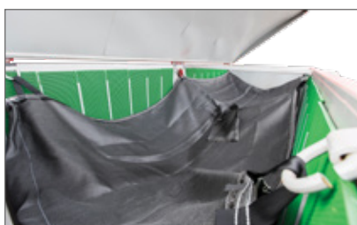
Geotextileinheit trennt effektiv Feststoffe von Wasser.
