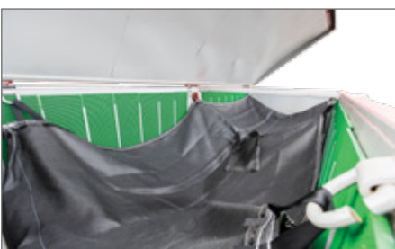
La bolsa de geotextil separa eficazmente los sólidos del agua.
